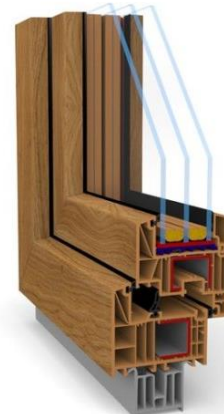
Bluevolution 82 Německý 6komorový profil značky Salamander se středovým těsněním, stavební hloubka 82 mm
