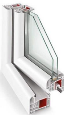
Gealan S8000IQ německý 6komorový profil s dorazovým těsněním, stavební hloubka 74mm
